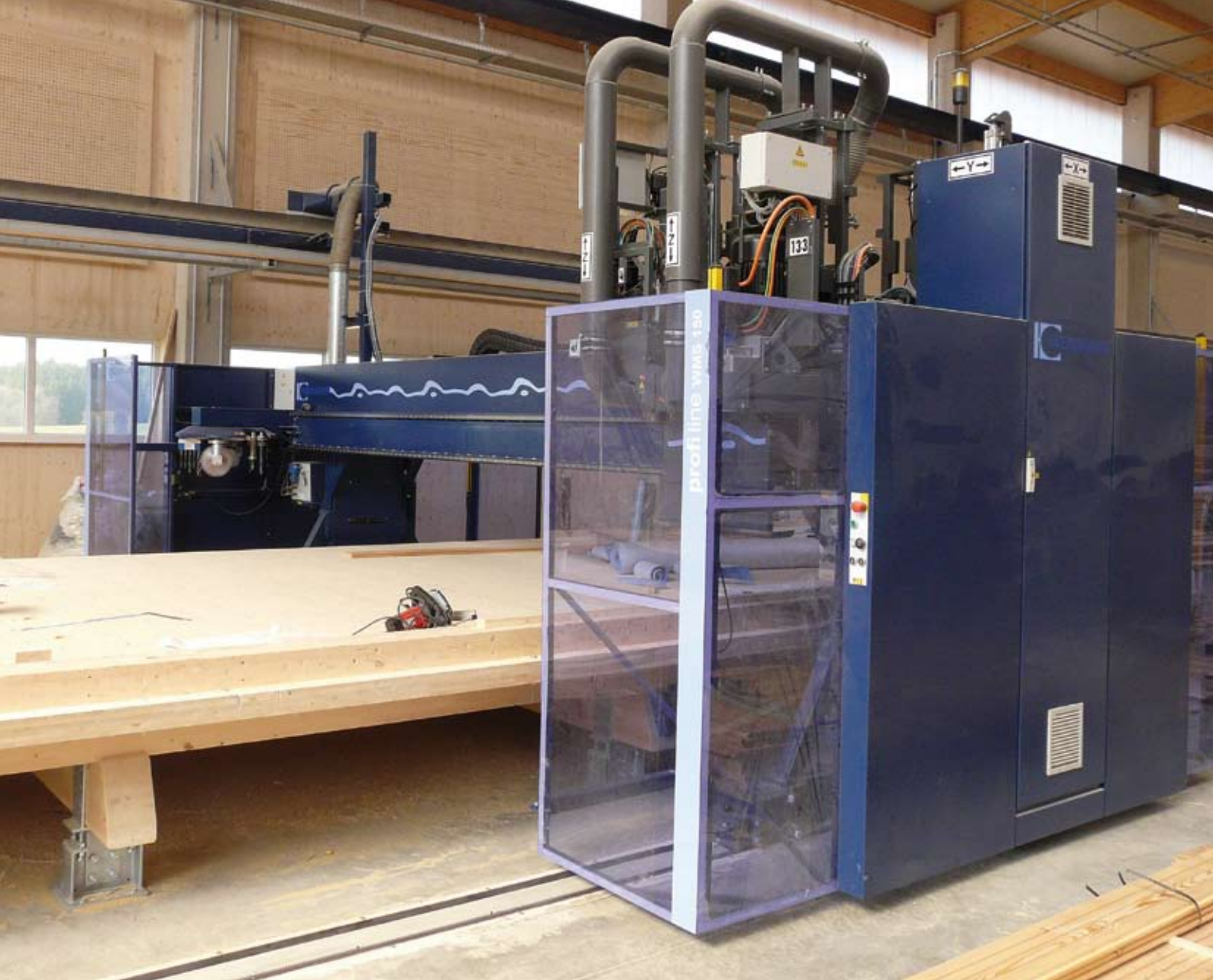
Jüngste Großinvestition: eine automatische Bearbeitungsbrücke für flächige Bauteile. Latest major investment: An automated processing bridge for flat components.
