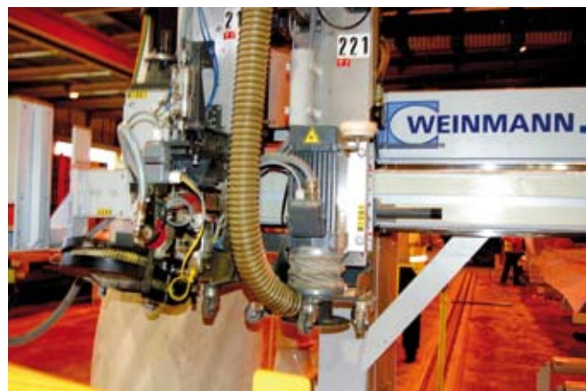
Die Wandlinie von Weinmann mit einem Young Black - Max CN890B Klammergerät an der Multifunktionsbrücke
