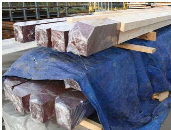
Dachhölzer eines Hauses, vor Regen geschützt, im Außenlager des Werks Roof timbers for a house in external storage, protected from the rain.
