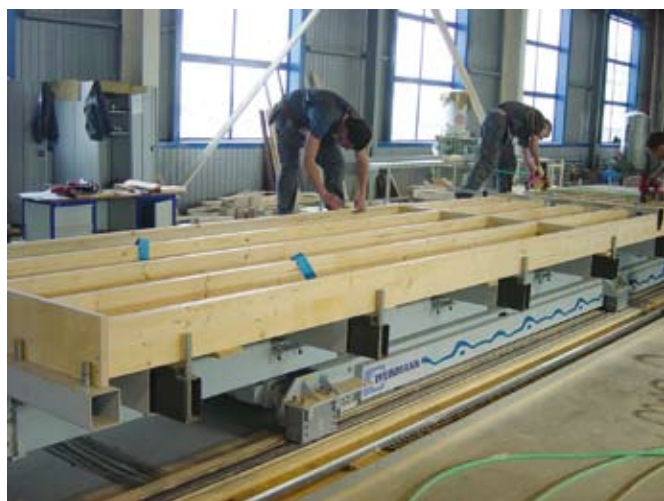
Nicht nur bei der Deckenproduktion werden Automatisierung und Handarbeit kombiniert. Automation and manual work are not only combined during ceiling production.
